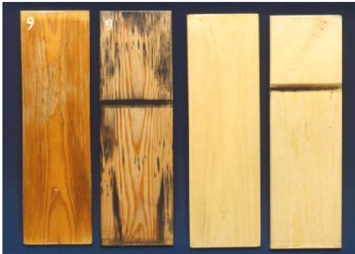
Abb. 10: UV-Stabilität von lackiertem (Klarlack) Holz. (v.l.n.r.: nicht acetylierte Holzprobe nach Schnellbewitterung, nicht acetylierte Probe nach 2 Jahren Außenbewitterung, acetylierte Holzprobe nach Schnellbewitterung, acetylierte Probe nach 2 Jahren Außenbewitterung).
