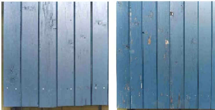
Abb. 11: Lackhaftung und Dauerhaftigkeit von Lacken auf acetyliertem Holz (links) und auf unbehandeltem Holz (rechts) nach 2 Jahren Außenbewitterung.
